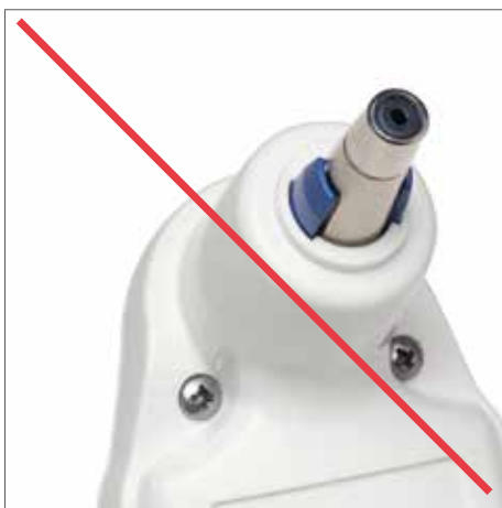
Een lens beschadigd met ammonium
