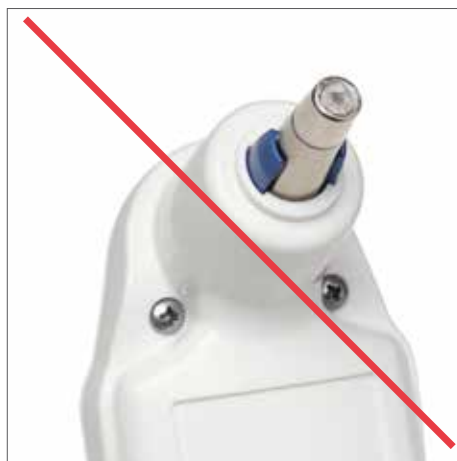
Een lens beschadigd met ammonium
